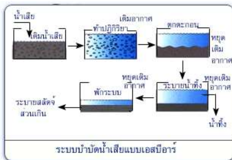
รูปที่ 5 – 7 ผังกระบวนการบำบัดน้ำเสียแบบแอกติเวเต็ดสลัดจ์แบบเอสปีอาร์
